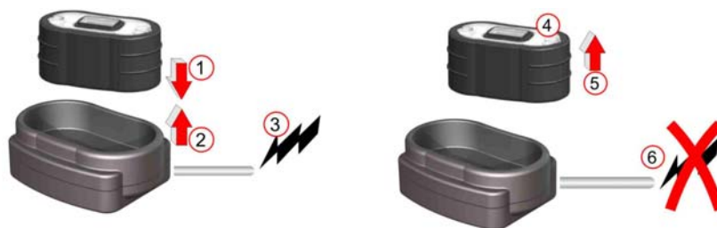
Figura 3 Colocação da Bateria no Carregador
