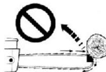
**REBOTE** é o golpe de retrocesso que se produz quando a ponta da barra guia toca um objeto (galho, ramo) durante o corte, ou quando se tenta penetrar na madeira com a ponta superior da barra. Isso ocorre porque o dente de corte da corrente fica em uma posição inclinada e tende a dar uma mordida maior na madeira do que pode cortar. Não podendo penetrar na madeira ou cortar o galho ou ramo quando a motosserra está em alta rotação, ocorre então a reação contrária, que é o rebote.
