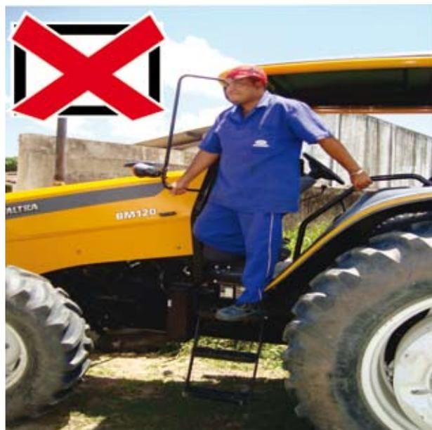
A estrutura de proteção ao capotamento e o cinto de segurança, formam uma zona chamada de zona de segurança, durante o capotamento, o operador estando dentro dela e utilizando o cinto de segurança, evitará que o mesmo sofra lesões ou pelo menos irá minimizar a gravidade do acidente.
