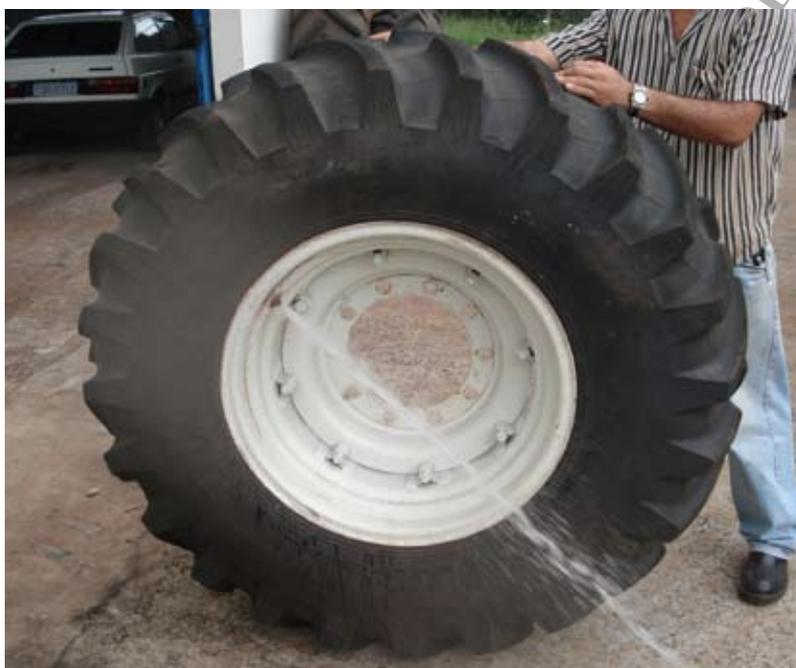
Bico a  $45^{\circ}$  na parte superior adição de 60 % de água no pneu
