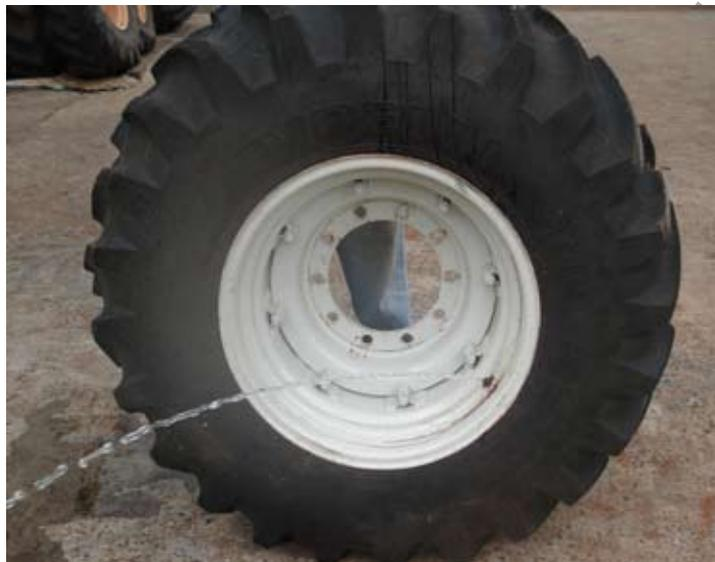
Bico a  $45^{\circ}$  na parte inferior adição de 40 % de água no pneu
