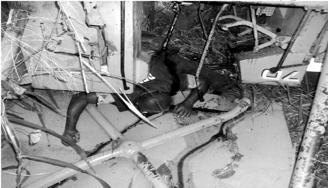
Trator sem estrutura de proteção ao capotamento (EPC)
