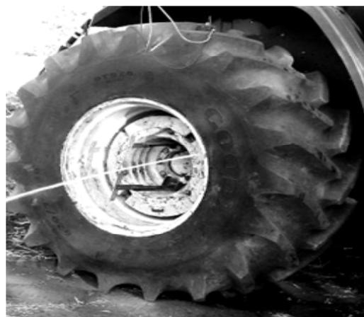
Bico na posição mediana adição de 50 % de água no pneu
