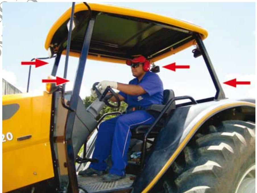
As Estruturas de Proteção ao Capotamento podem ser de três tipos:
