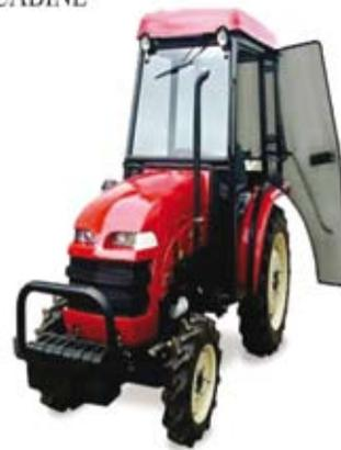
Tipos de estrutura de proteção ao capotamento (EPC)
