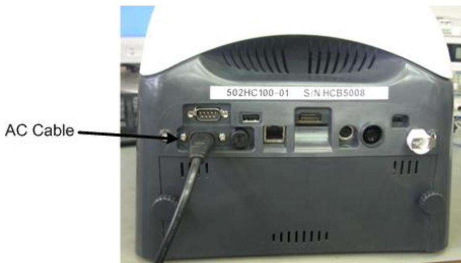
Figura 2-3: Cabo de força conectado ao iVent 101
