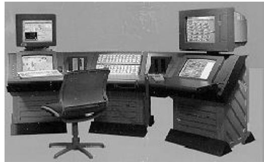
Fig. 3.8. Console de computador de um sistema digital de controle distribuído
