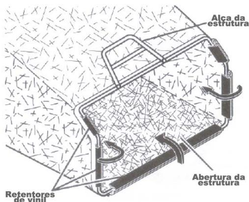
**⚠ CUIDADO:** Sob condições normais de uso, o material do coletor está sujeito a deterioração e desgaste, devendo, portanto, ser verificado frequentemente quanto à necessidade de substituição. Qualquer coletor sobressalente deve ser verificado para garantir a conformidade com as especificações do fabricante original.
