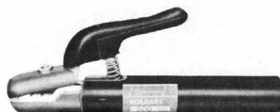
**Grampo de retorno**, também chamado de terra, que é preso à peça ou à tampa condutora da mesa sobre a qual está a peça. Quando se usa uma fonte de energia de corrente contínua, ele faz a função do pólo positivo ou do pólo negativo, de acordo com a polaridade escolhida.
