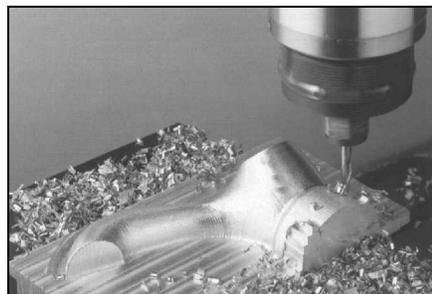
O ser humano só aparece novamente para dar o acabamento final da superfície do modelo, eliminando as marcas deixadas pela ferramenta. A habilidade, visão e tato humanos necessários à realização desta tarefa ainda não conseguiram ser incorporados com sucesso em máquinas automáticas. Pronto e acabado o modelo, passa-se à construção do molde.
