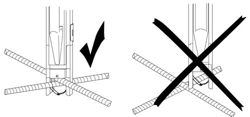
Assegure-se que a abertura de alimentação fixa sempre os aços de armação. Se colocar sem querer a aparelho ao lado, é realizada uma fixação "falsa". O arame de atar permanece no aparelho e encrava.
