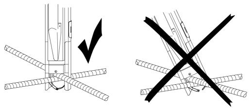
Coloque o aparelho com a abertura de alimentação até ao fundo da caixa em ângulo recto com os aços de armação, de forma a que as braçadeiras dos arames de atar se possam encaixar.
