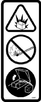
**ETIQUETA DE MATERIAL INFLAMÁVEL - LOCALIZADA NO LADO INTERNO DA TAMPA DO TANQUE E NO LADO ESQUERDO DO COMPARTIMENTO DO OPERADOR.**
