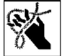
**Nunca segure o cabo rotativo usando um trapo ou uma luva de algodão folgada. Ambos poderiam se enrolar no cabo, ocasionando graves lesões.**
