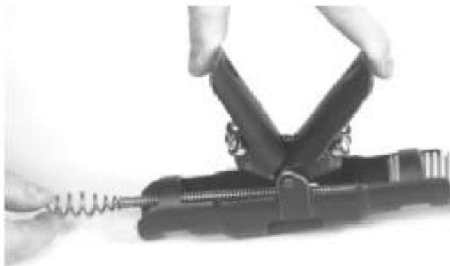
Figura 3 – Passagem do cabo pelo conjunto AUTOFEED®
