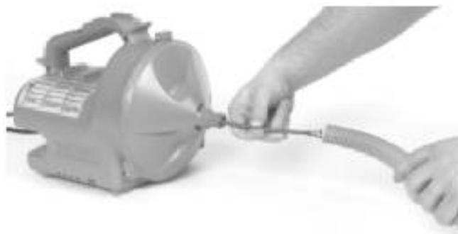
Figura 2 – Inserção do cabo no tubo de guia
