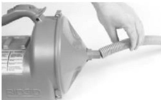
Figura 4 – Acoplamento da mangueira-guia
