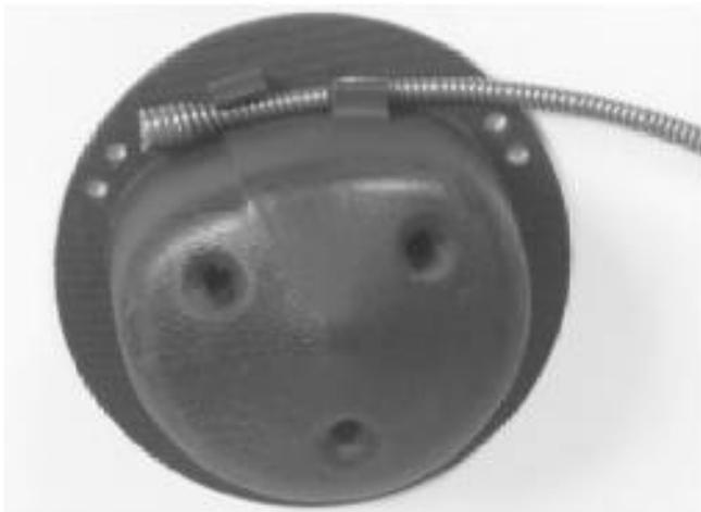
**Figura 9 – Fixação do cabo no tambor interno**
