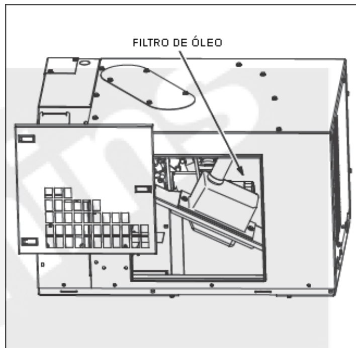
FIGURA 7. ACESSO AO FILTRO DE ÓLEO ATRAVÉS DA PARTE FRONTAL
