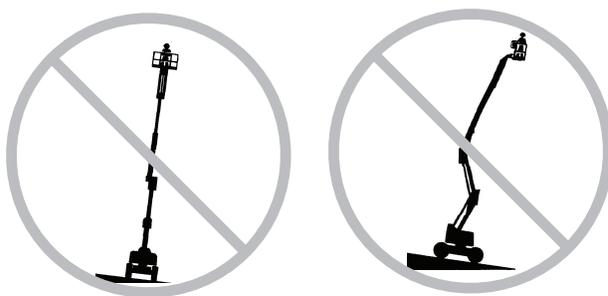
Não dependa do alarme de inclinação como um indicador de nível. O alarme de inclinação soará na plataforma somente quando a máquina estiver em declive acentuado.
