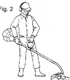
Ajuste a distância da empunhadura para uma posição mais confortável (de fácil operação e controle do equipamento) (fig.2) e em seguida aperte firmemente os parafusos de fixação. Ajuste a posição conforme indicado na figura 3.
