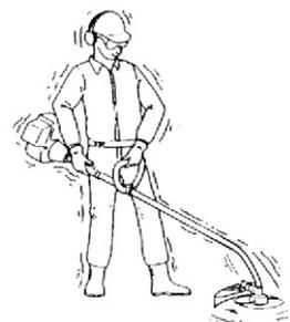
A vibração repentina do equipamento é um sinal de problema grave no mesmo, como quebra da ventoinha, da embreagem ou do acessório de corte, ou ainda afrouxamento de qualquer parte do equipamento. Pare imediatamente e não trabalhe com o equipamento nessas condições ou até que o problema seja solucionado.
