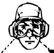
O operador deve usar os óculos de proteção não somente para proteger a vista contra qualquer objeto arremessado pela lâmina de corte, como também para evitar inflamação dos olhos causada pela poeira, pólen e sementes que possam entrar em contato com eles.
