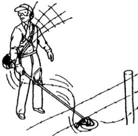
Não trabalhe próximo a cercas de arame ou em locais onde exista cerca de arame, uma vez que fio de nylon, em alta rotação, pode enrolar-se com o arame e este no aparelho de fio de nylon girando em alta rotação e chicoteando tudo ao redor.
