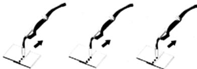
Chapas sobrepostas podem ser soldadas com uma espessura máxima de 0,8 mm.
