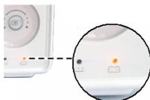
A bateria será automaticamente recarregada enquanto o BM1 estiver conectado à fonte de alimentação DC. O LED da bateria fica iluminado enquanto o BM1 estiver em uso sem a energia DC.
