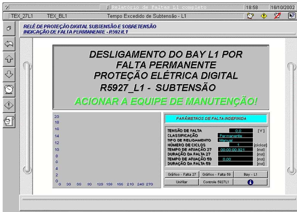
Figura 4.13 - Apresentação da tela de falta de subtensão permanente no bay da carga L1
