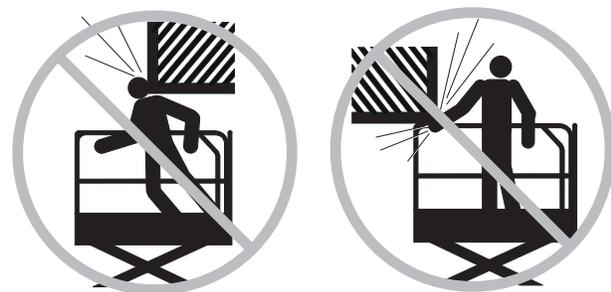
Fique atento ao risco de esmagamento ao segurar o trilho de proteção da plataforma.
