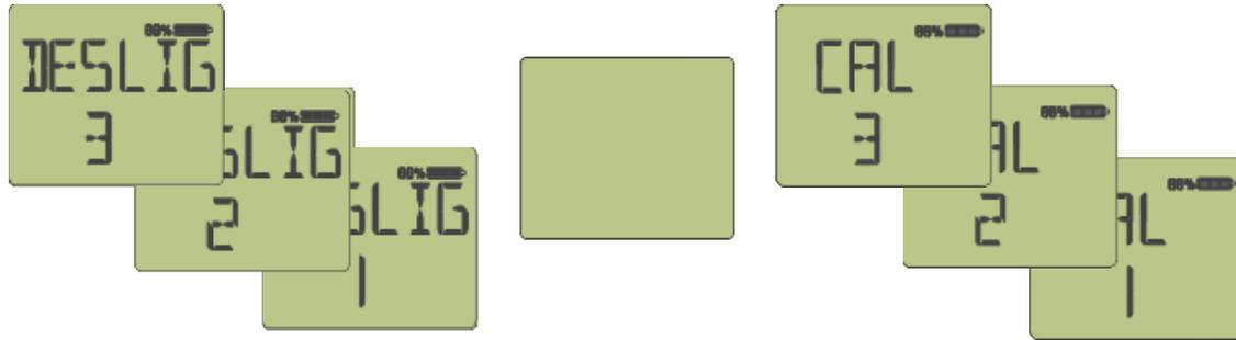
O detector primeiro zerará automaticamente todos os sensores na leitura de base atual. Então, o detector pedirá a aplicação de gás.
