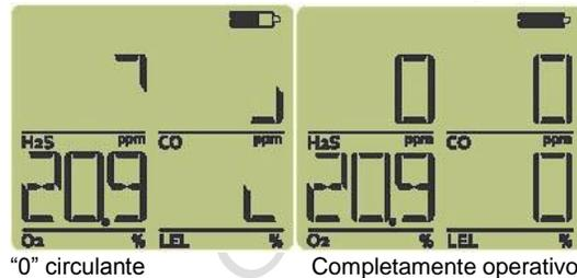
Quando todos os sensores tiverem completado a sequência de aquecimento, o detector estará pronto para detectar todos os gases.
