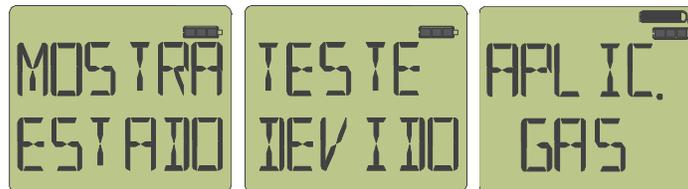
O detector alternará entre "TESTE DEVIDO" e "APLIC GAS". Aplique gás na unidade com uma vazão de 0,25 a 0,5 Lpm, utilizando a tampa de calibração fornecida. Quando todos os sensores tiverem apresentado alarme, a unidade voltará ao funcionamento normal (de alarme) e a data de realização do teste de resposta será restabelecida.
