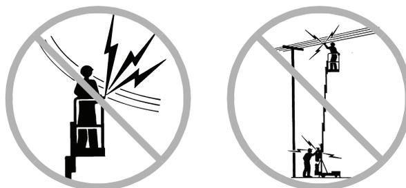
Mantenha-se afastado da máquina em caso de contato com linhas de alimentação energizadas ou se ela ficar eletricamente carregada. As pessoas que estiverem no solo ou na plataforma não devem tocar ou operar a máquina até que as linhas de alimentação energizadas sejam desligadas.
