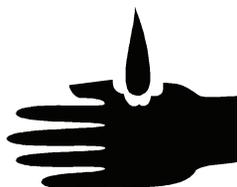
Evite derramamento do ácido da bateria ou contato com ele. Neutralize o ácido de bateria derramado com bicarbonato de sódio e água.
