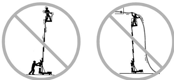
Não exerça forças horizontais nem crie cargas laterais na máquina, elevando ou baixando cargas fixas ou suspensas.
