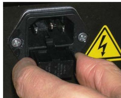
Premindo as patilhas entre o polegar e o indicador é possível extrair completamente pela tomada filtrada o alojamento porta-fusíveis (figuras 5.4.d) e substituir o(s) fusível(eis) como ilustrado nas figuras 5.4.e.
