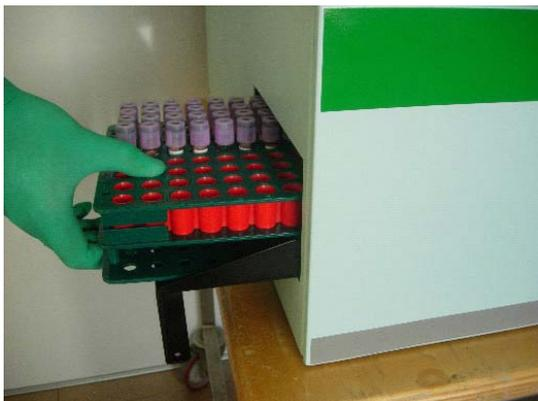
**fig. 2.2.2 lado esquerdo do Ves-Matic Cube 80 (Suporte porta-amostras em saída)**
