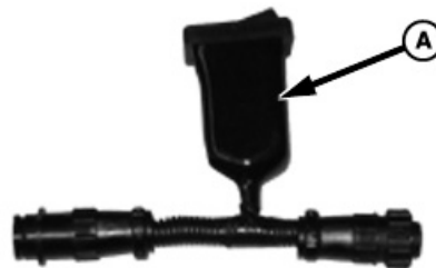
Interruptor da Alimentação do Motor do ATU
