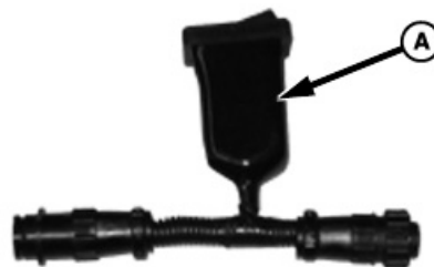
Interruptor da Alimentação do Motor do ATU
