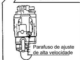
Parafuso de ajuste de alta velocidade
