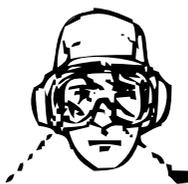
O operador deve usar os óculos de proteção não somente para proteger a vista contra qualquer objeto arremessado, como também para evitar inflamação dos olhos causada pela poeira, pólen e sementes que possam entrar em contato com eles.
