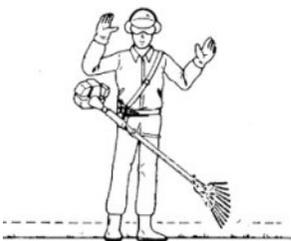
Utilize a alça de sustentação como indicado neste manual. Ajuste a alça de sustentação e a posição da argola de fixação da alça, de modo que o equipamento fique posicionado no lado direito do operador como indicado na figura.
