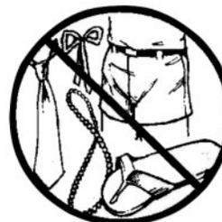
O operador não deve vestir roupas folgadas ou com partes em excesso ou soltas que possam se prender em alguma parte móvel do equipamento. Em compensação, elas não podem ser justas ao ponto de limitarem os movimentos do operador.
