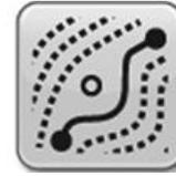
A Pista de Curva Adaptável permite que o operador registre um caminho de curva dirigida manualmente. Assim que o primeiro passe curvo for gravado e a máquina for virada, o operador pode usar o Parallel Track ou ativar o AutoTrac quando o caminho propagado aparecer.
