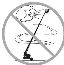
Não eleve a lança se a velocidade do vento for superior a 12,5 m/s. Se a velocidade do vento exceder 12,5 m/s quando a lança estiver elevada, abaixe-a e não continue a operar a máquina.
