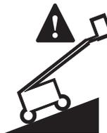
Se o alarme de inclinação soar quando a plataforma for elevada, a lâmpada indicadora de máquina desnivelada se acenderá e a função de movimento em uma ou ambas as direções não operará. Identifique a condição da lança na inclinação, como mostrado a seguir. Siga as etapas para abaixar a lança antes de mover a máquina para uma superfície nivelada e firme. Não gire a lança durante o procedimento de abaixamento.
