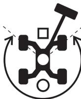
Para movimentar, mova a chave de habilitação de movimento e mova lentamente a alavanca de controle de movimento/direção para fora do centro.
