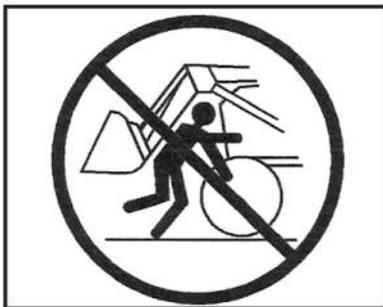
Nunca efectue a manutenção e reparação do carregador frontal com este levantado. Baixar o carregador frontal para o solo. Desmonte o carregador frontal do tractor para efectuar a manutenção e a reparação.
