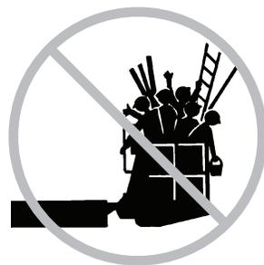
Não utilize a máquina sobre uma superfície móvel ou em movimento, nem sobre veículos.
