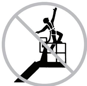
Não sente, não fique em pé e nem suba nas barras de proteção da plataforma. Mantenha-se sempre firme no piso da plataforma.
