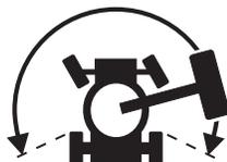
Para acionar, segure a chave de habilitação de movimento em um dos lados e mova lentamente a alavanca de controle de movimento para fora do centro.
