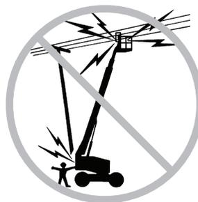
Mantenha-se afastado da máquina em caso de contato com linhas de alimentação energizadas. As pessoas que estiverem no solo ou na plataforma não devem tocar nem operar a máquina até que as linhas de alimentação energizadas sejam desligadas.
