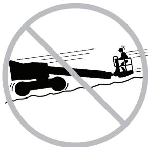
Não opere uma lança na rota de um guindaste, a menos que os controles do guindaste tenham sido travados e/ou tenham sido tomadas precauções para evitar uma colisão em potencial.
