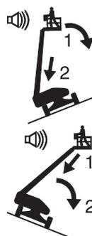
Se o alarme de inclinação soar com a plataforma em aclive: primeiro abaixe a lança e, em seguida, retraia a lança.
