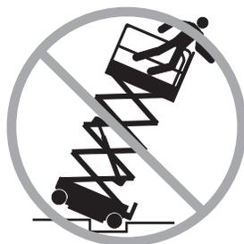
Dirija a máquina na posição retraída, com extremo cuidado e em baixa velocidade, ao passar por terrenos irregulares, detritos, superfícies instáveis ou escorregadias e próximo a buracos e declives acentuados.
