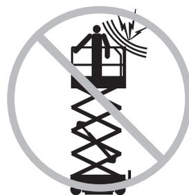
Afaste-se da máquina se vier a encostar em linhas de alimentação energizadas. As pessoas que estiverem no solo ou na plataforma não devem tocar nem operar a máquina até que as linhas de alimentação energizadas sejam desligadas.
