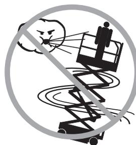
Não opere a máquina se houver ventos fortes ou rajadas de vento. Não aumente a área da superfície da plataforma ou da carga. O aumento da área exposta ao vento reduz a estabilidade da máquina.
