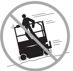
Limite a velocidade do percurso de acordo com as condições da superfície, de congestionamento, inclinação, localização de pessoas e quaisquer outros fatores que possam causar colisões.
