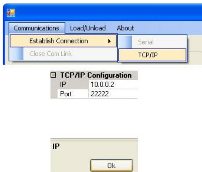
Figura 6. 6 – Menu *Communications* e Configuração de Comunicação *TCP/IP*
