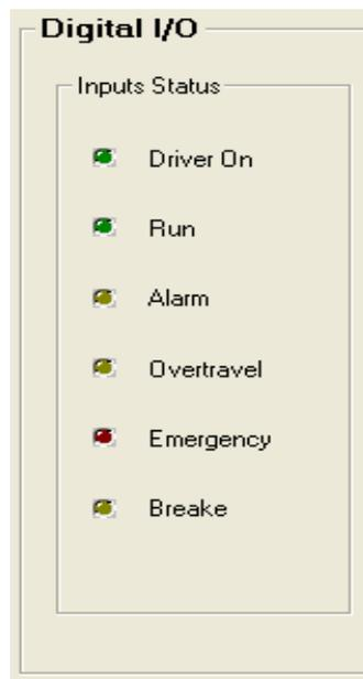
**Figura 3. 4 – Painel que replica os Sinalizadores do Armário Eléctrico do Robô Cartesiano**
