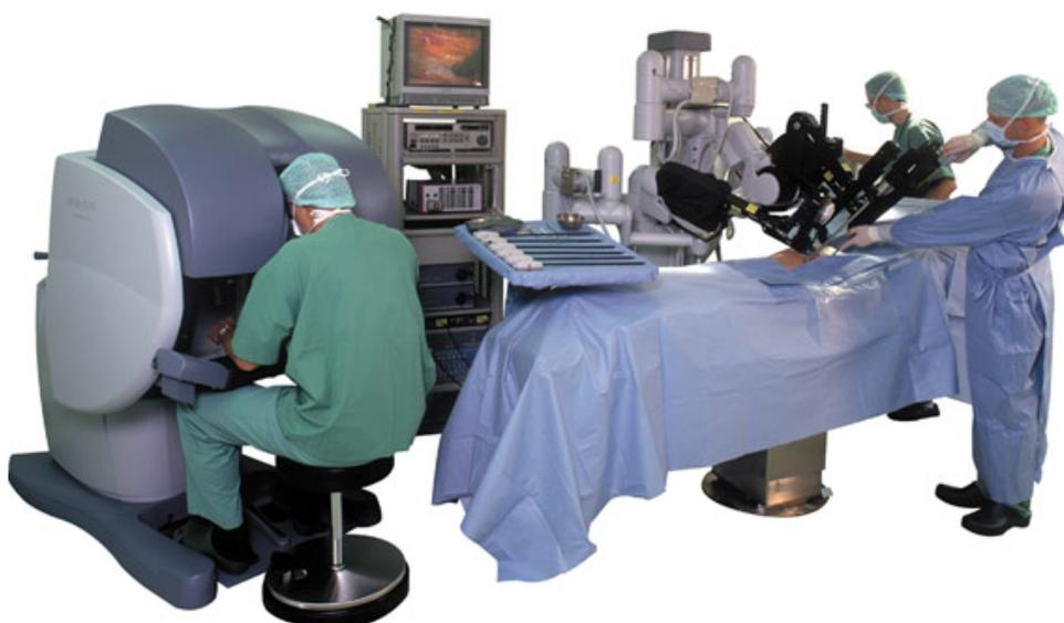
**Figura 1. 6 – Sistema Robótico de Telemanipulação “Da Vinci” (www.nextgenmd.org)**
