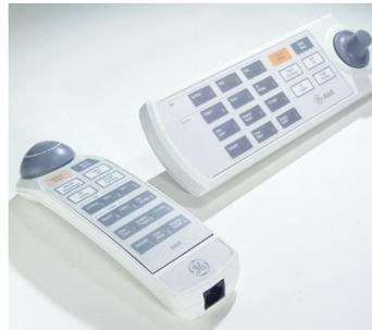
O controle remoto e o teclado fornecem todos os controles do monitor do paciente num componente portátil com um botão de controle **Trim Knob**. O controle remoto é ligado ao monitor do paciente através de um dos conectores USB na parte traseira da unidade de processamento ou na parte de baixo do visor. O teclado é ligado a uma porta M e pode ser montado no visor ou num suporte separado que tenha várias configurações de montagem.
