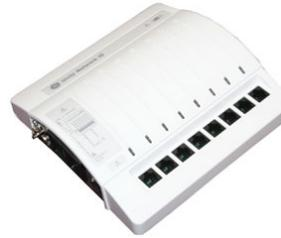
O dispositivo de conectividade do DI da Rede Unity adquire dados digitais de oito portas de série individualmente isoladas. Os dados são recolhidos de até oito dispositivos periféricos (não necessariamente fabricados pela GE) e, em seguida, o dispositivo transmite os dados formatados ao monitor.
