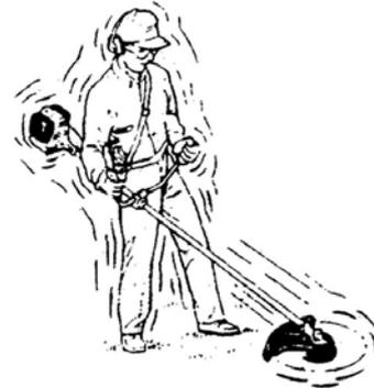
Caso a lâmina prenda na madeira ou capim, não tente livrá-la acelerando o motor o mexendo o equipamento, uma vez que forçará o equipamento e entortará a lâmina. Caso isto ocorra, desligue o motor e manualmente (com luvas de proteção) solte a lâmina de corte.
