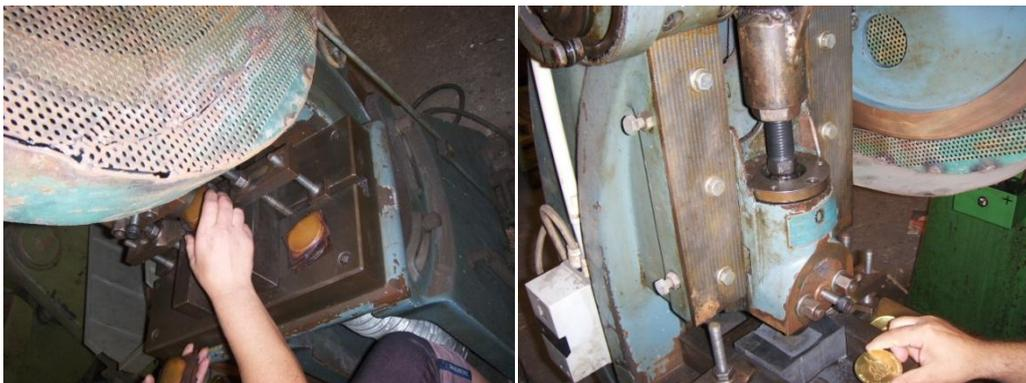
Figura 28 - Zona das ferramentas no processo de embutidura (imagem esquerda) e processo de curvatura (imagem da direita).
