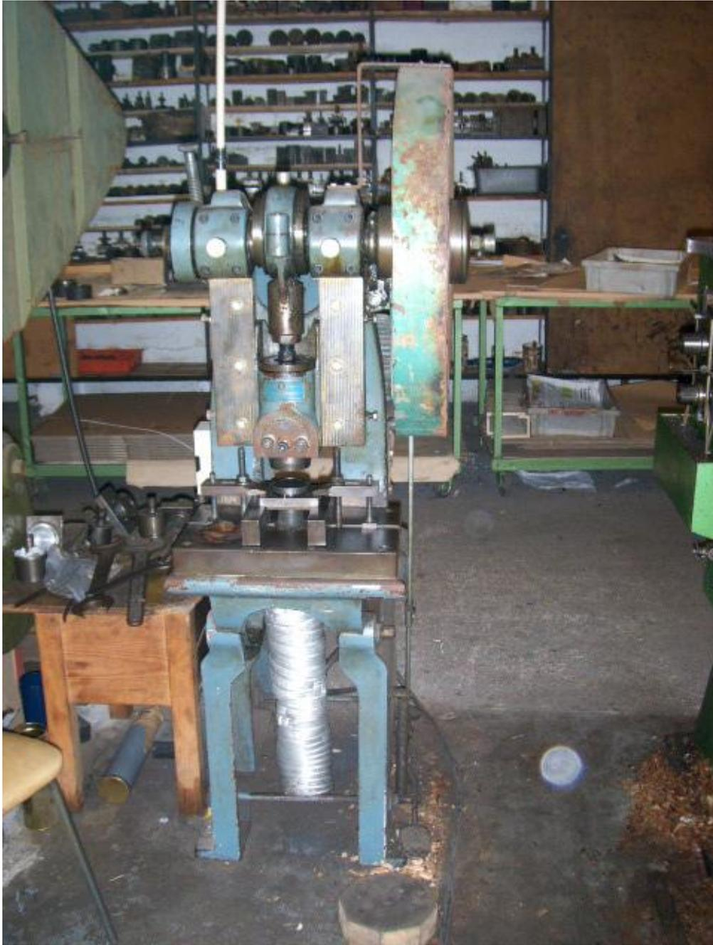
**Figura 29 - Imagem frontal da prensa, nesta imagem é possível verificar que as partes móveis da zona das ferramentas encontram-se desprotegidas. É possível verificar também o mau estado das protecções da zona de transmissão de potência.**
