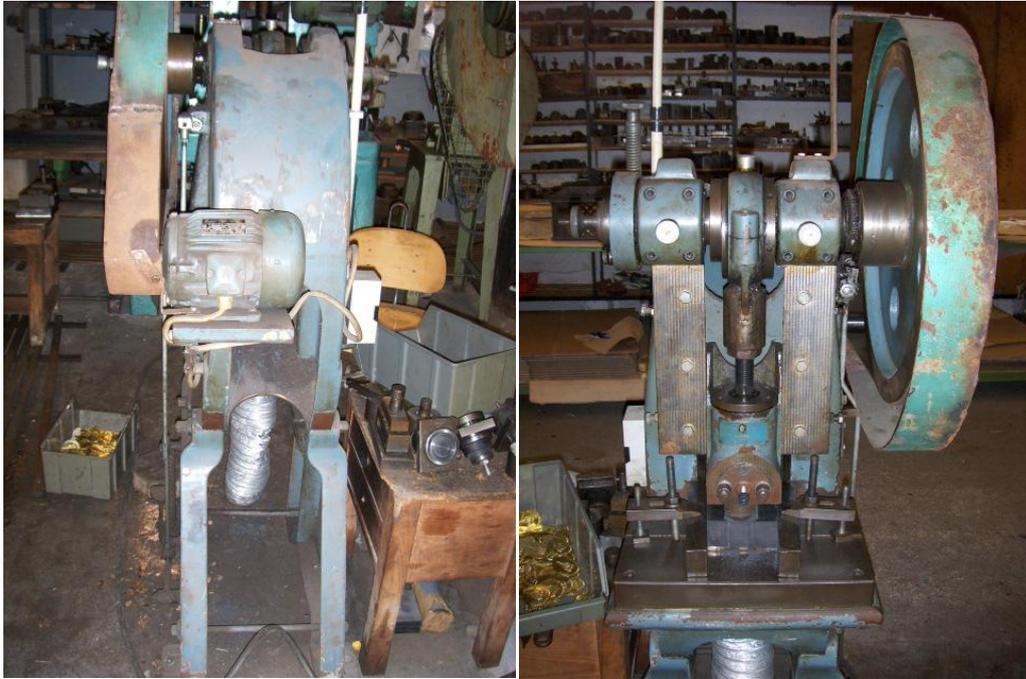
Figura 27 - Prensa mecânica de revolução completa, na imagem da esquerda é possível a zona posterior à zona das ferramentas, onde está situado o motor eléctrico. E na imagem da direita encontra-se a zona das ferramentas.
