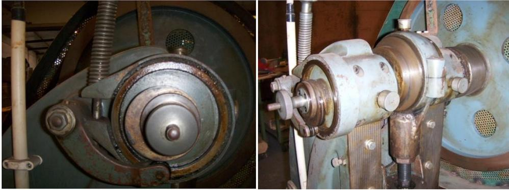
**Figura 30 - Na imagem da esquerda é possível visualizar o travão da prensa, enquanto na direita é possível visualizar a cambota, biela e volante.**
