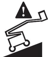
A lâmpada acesa indica que a máquina está desnivelada. Quando essa lâmpada estiver acesa, o alarme de inclinação soará. Mova a máquina para uma superfície firme e nivelada.
