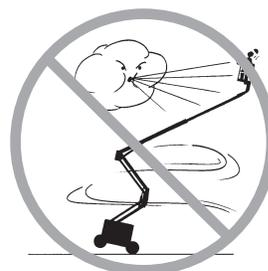
Não eleve a plataforma se a velocidade do vento for superior a 28 mph / 12,5 m/s. Se a velocidade do vento exceder 28 mph / 12,5 m/s quando a plataforma estiver elevada, abaixe a plataforma e não continue a operar a máquina.
