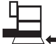
Se o amortecedor da plataforma entrar em contato com um objeto, a máquina desligará e nenhuma função irá operar.
