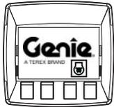
A tela LCD exibe horímetro, tensão, pressão do óleo e temperatura do fluido refrigerante. A tela também exibe códigos de falha e outras informações de serviço.
