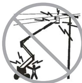
Afaste-se da máquina se vier a encostar em linhas de alimentação energizadas. As pessoas que estiverem no solo ou na plataforma não devem tocar nem operar a máquina até que as linhas de alimentação energizadas sejam desligadas.
