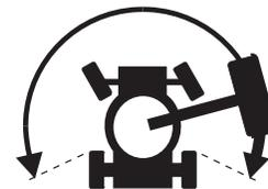
Observação: quando o sistema de habilitação de movimento estiver em uso, a máquina poderá movimentar-se no sentido oposto ao do movimento da alavanca de controle de movimento e direção.
