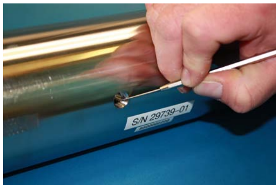
Figura B-10 Remoção do excesso de fita de vedação da flange
