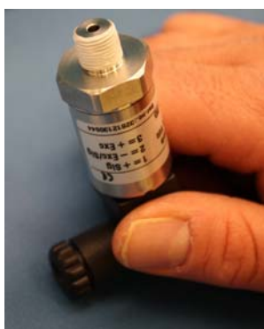
Figura B-18 Substituição da fita de vedação
