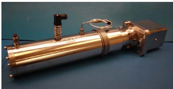
Figura B-14 Novo transdutor de pressão instalado
