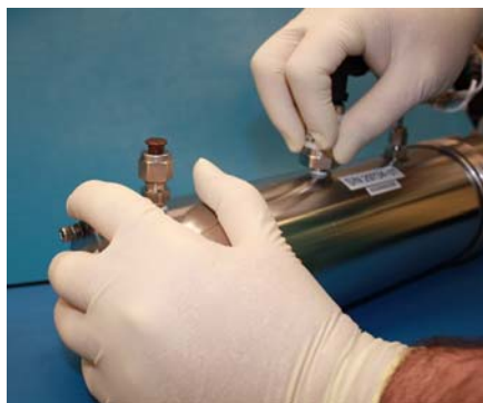
Figura B-13 Substituição do transdutor de pressão
