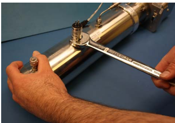
Figura B-9 Remoção do transdutor de pressão antigo
