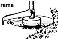
**VARREDURA** - A ação de sopro da linha giratória pode ser usada para soprar os detritos soltos na área. Mantenha a linha paralela com e acima da superfície da área e movimente a ferramenta de um lado para o outro.
