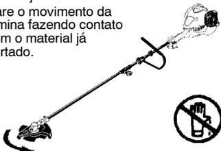
**⚠️ ADVERTÊNCIA:** Inspeção a área a ser cortada antes de cada uso. Remova objetos (pedras, vidro quebrado, pregos, fios, etc.) que possam ser arremessados ou ficarem presos na lâmina ou linha da roçadeira.
