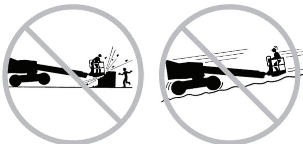
Limite a velocidade de operação de acordo com as condições da superfície, do congestionamento e da inclinação do solo, da localização de pessoas e de quaisquer outros fatores que possam provocar colisão.
