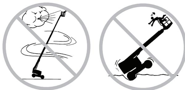
Dirija a máquina na posição retraída, com extremo cuidado e em baixa velocidade, ao passar por terrenos irregulares, detritos, superfícies instáveis ou escorregadias e próximo a buracos e declives acentuados.
