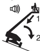
Não eleve a lança se a velocidade do vento for superior a 12,5 m/s. Se a velocidade do vento exceder 12,5 m/s quando a lança estiver elevada, abaixe-a e não continue a operar a máquina.
