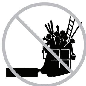
Não coloque escadas ou andaimes na plataforma ou apoiados em qualquer parte da máquina.
