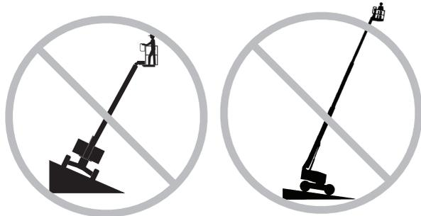
Não dependa do alarme de inclinação como um indicador de nível. O alarme de inclinação soará na plataforma somente quando a máquina estiver em declive acentuado.
