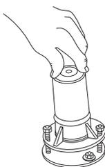
14 Pressione um dos lados do sensor de inclinação.
