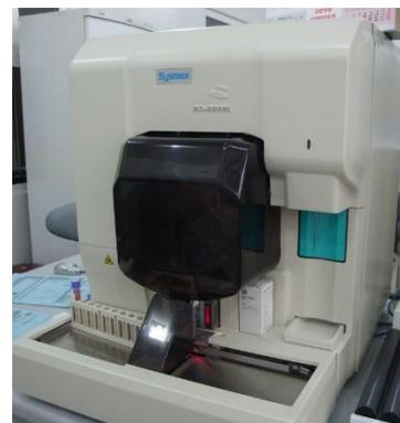
Figura 10: Contador hematológico Sysmex XT-2000i
