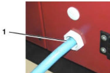
Prestar atenção para que o cabo não entre em contacto, acidentalmente, com partes em movimento ou que alcancem temperaturas elevadas; se necessário fixar com braçadeiras.
