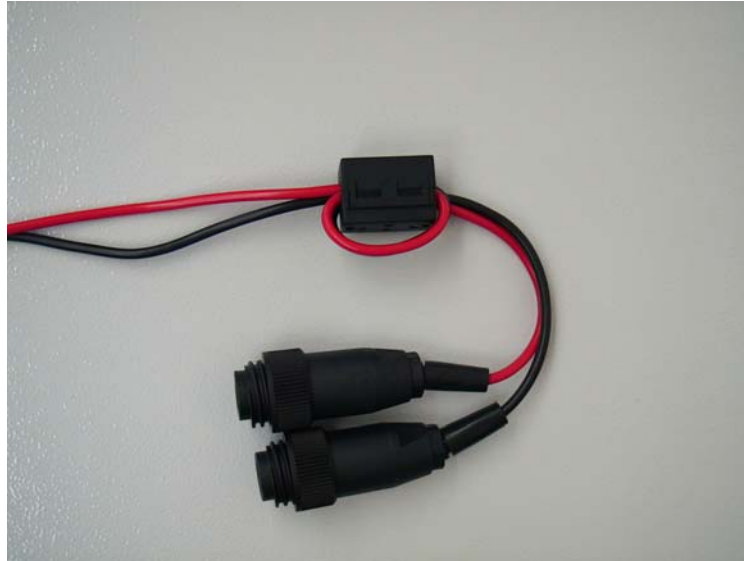
Fig. 1 Posição do filtro supressor de radiointerferencias na proximidade dos conectores
