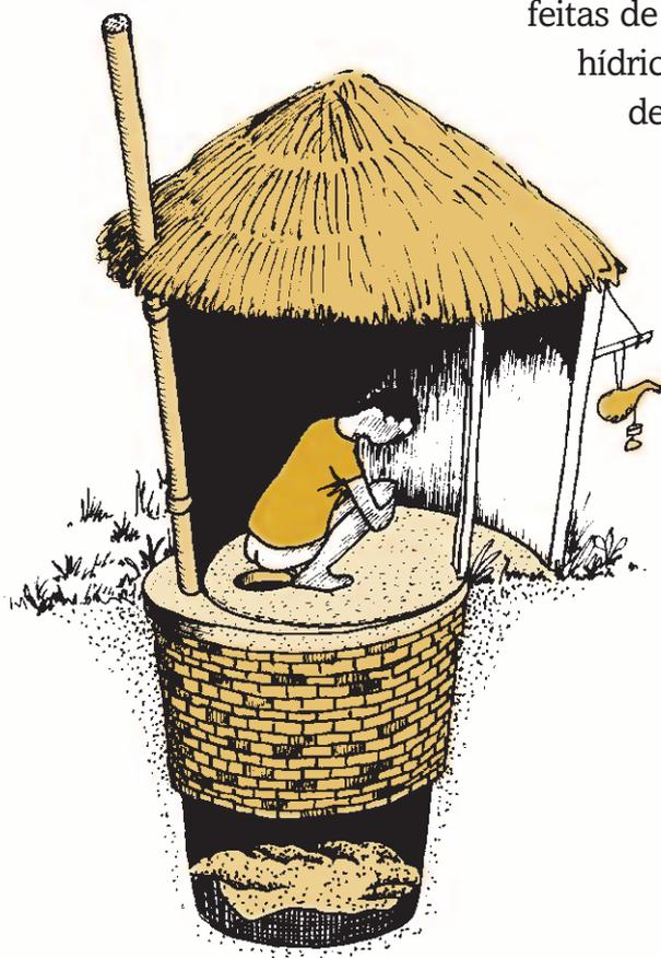
Latrinas FVA são construídas com um cano plástico longo ou uma chaminé de tijolos embutidos dentro da laje do piso e se estendendo acima do telhado. O topo do cano ou chaminé é coberto com uma tela fina para capturar moscas. À medida que as moscas voam do buraco da latrina, em direção à luz, elas ficam presas e morrem. O cano ajuda a reduzir o mau cheiro. Este tipo de latrina precisa ter o interior escuro com a porta se abrindo para o lado oposto ao sol.
