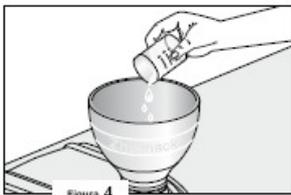
**Fig. 4:** Utilizando um dosador, adicionar na cuba a quantidade de água necessária de acordo com as características do produto usado.
