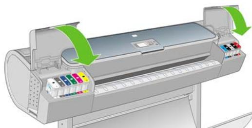
6. O visor do painel frontal confirma se todos os cartuchos foram inseridos corretamente, pressione a tecla **OK** no painel frontal.
