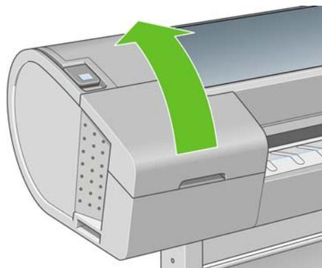
5. Pressione o botão atrás dos cartuchos de tinta para liberar a tampa na extremidade esquerda da impressora.
