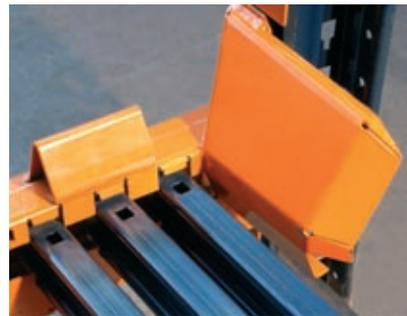
As vigas dianteiras contam com apoio e fixação, assim como de batentes e orifícios, que permitem que se ressalte um indicador de presença de carro disponível, necessário principalmente nos níveis elevados.
