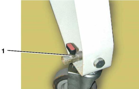
Para o pressóstato descarregar a condensação pelo menos uma vez por semana deste modo, certificar-se que a máquina esteja parada e não esteja ligada à energia eléctrica. Utilizar um recipiente para a recolha da condensação. Abrir a portinhola esquerda da máquina com a respectiva chave, abrir lentamente a torneira 2, deixar correr até que não saia mais condensação pela torneira, recolhendo essa condensação no recipiente adequado.
