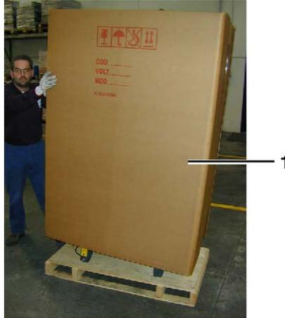
Desapertar os parafusos 1 de fixação dos pés que fixam o compressor à palete (só nos modelos com depósito).
