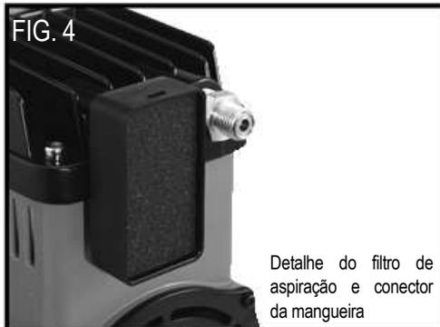
Detalhe do filtro de aspiração e conector da mangueira
