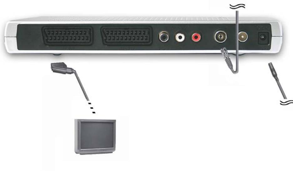
Figura 3.3: Ligação ao televisor através de conector SCART
