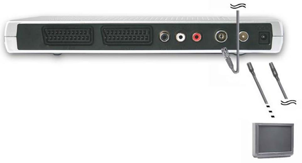
Figura 3.4: Ligação ao televisor através de um cabo de antena
