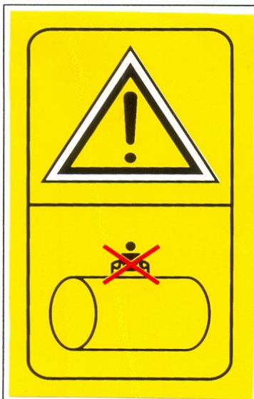
NÃO ENTRE NO TANQUE
