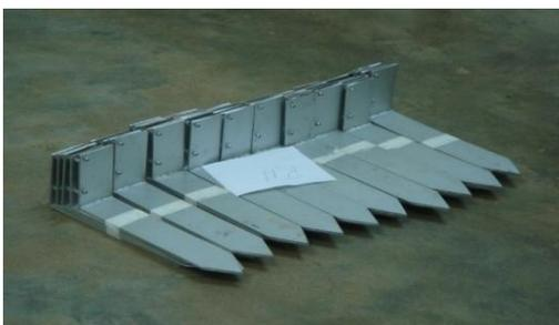
Figura 6 – Barras de metal (alumínio) padrão a serem enterradas no ponto central das unidades amostrais e no início de cada subunidade.
