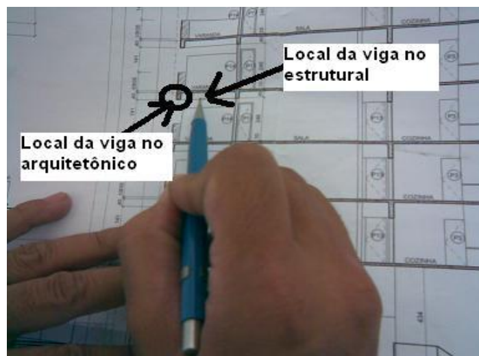
Figura 27 – Mostrando incompatibilidade no posicionamento da viga 25
