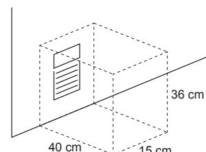
Tijdens het gebruik van de sauna dient de stoomuitlaat niet afgesloten te zijn met kleding of voorwerpen die de uitstromen van de stoom belemmeren.
