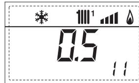
4. Visualização da temperatura sonda auxiliar
